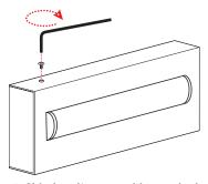
4) Chiudere l'apparecchio tramite le apposite viti 4) Close the device using the screws
